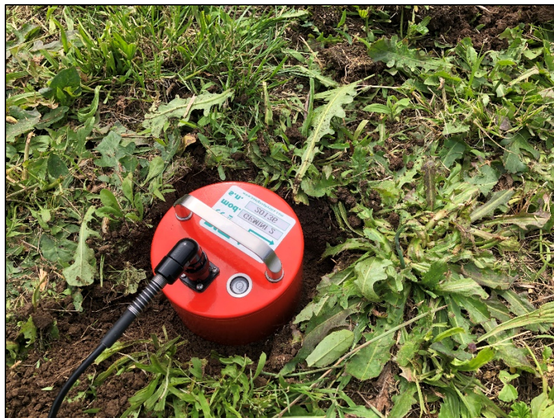
Dettaglio del sensore di acquisizione HV3
