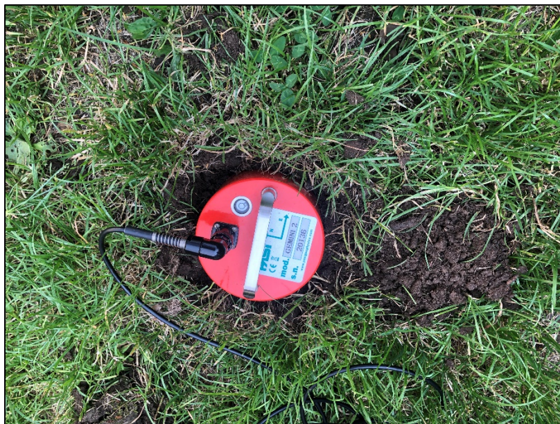
Dettaglio del sensore di acquisizione HV1
