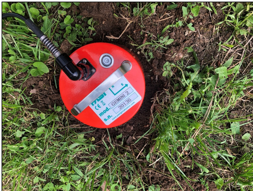
Dettaglio del sensore di acquisizione HV2
